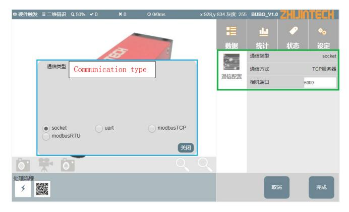
通过配置通信方式,算子处理结果会通过对应的方式传递给外部设备。目前支持的通信方式包括 socket、uart、modbusTCP、modbusRTU。传输的数据格式请参照具体算子。
