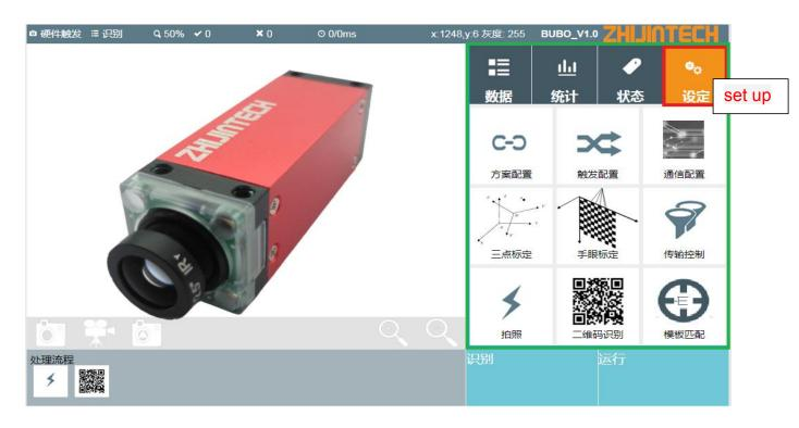
设定页面包含了所有供用户配置的相关算子,例如:实现多方案配置的"方案配置"算子,触发条件设定的"触发配置"算子,以及通信配置、传输控制、曝光配置、二维码识别,点击相应图标即可对其进行设置。可以在确定需求的情况下依次选取所需的算子进行设置然后在点击对话框中的完成选项即可保存到处理流程的区域。如果算子数量超过一页可显示的9个,用户可以通过将鼠标移至以上所示红框区域中一>按住鼠标左键上下拖动查看更多的算子。
